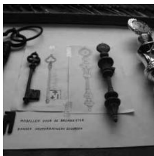
Houten mallen voor bronsgieterij van sleutel en scepter
